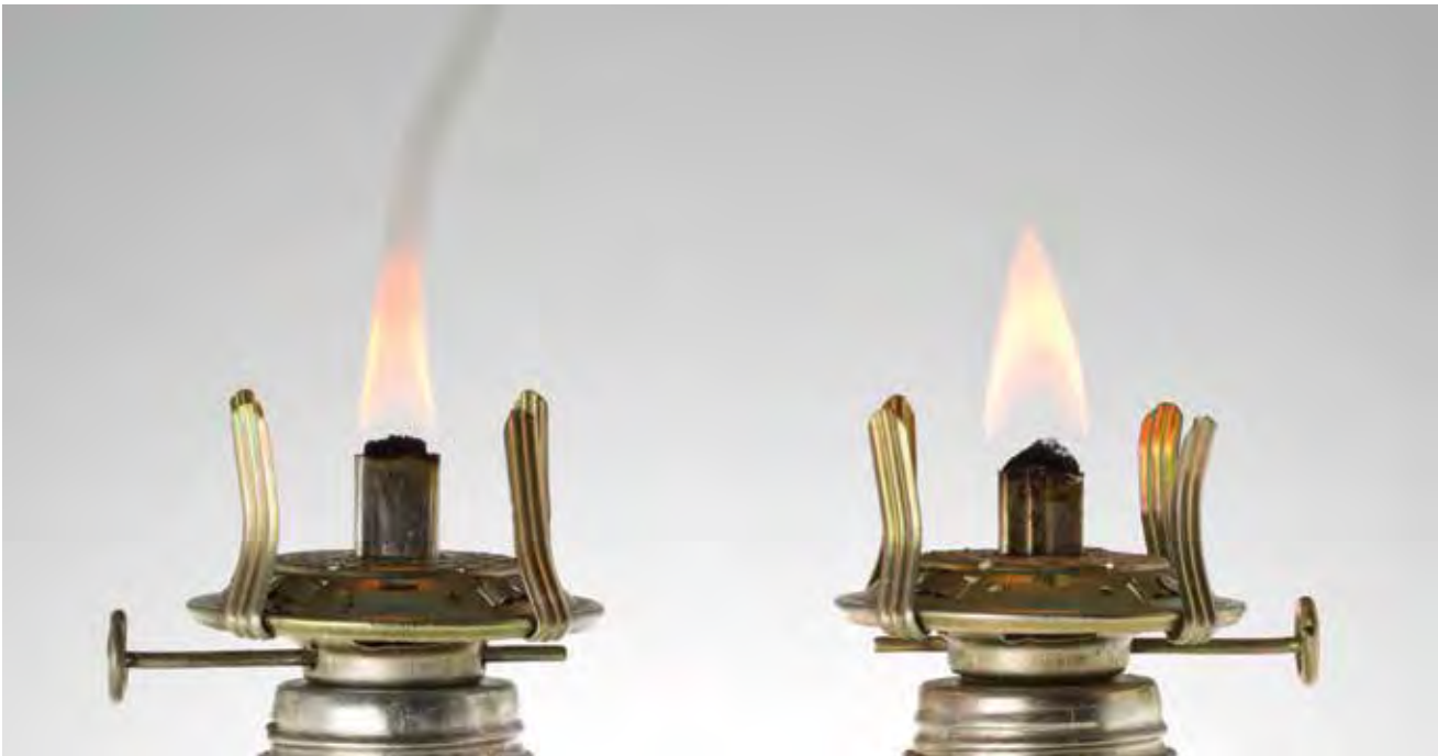
VISUALISIERUNG DER RUSSVERRINGERUNG. STANDARD DIESEL (LINKS ) UND SHELL GTL FUEL (RECHTS )
