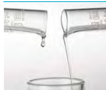
VISKOSITÄT VON SHELL GTL FUEL (LINKS)
